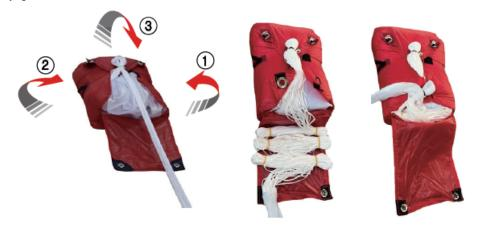
下部サスペンションラインを「8の字」パターンで収納し、各ペアの両端をゴムバンドで固定します。
